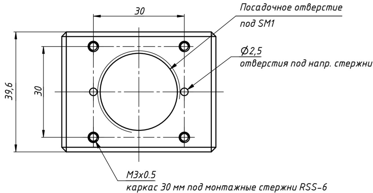
Куб монтируется в каркасную систему с помощью монтажных стержней RSS-6. Стержни вкручиваются в куб, для этого предусмотрены резьбовые отверстия M3. Также на четырех гранях куба сделаны резьбовые отверстия SM1 (1.035"-40) для установки оптических элементов Ø1" или оптических тубусов. Сверху и снизу имеются установочные отверстия для вращательной и юстируемой платформ.
